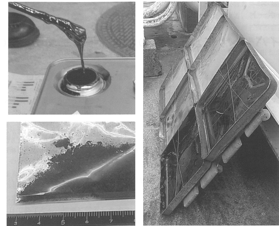
図2 対象としたタールエポキシ樹脂塗料 (左上)、塗膜試料 (左下) と屋外暴露の様子 (右)
